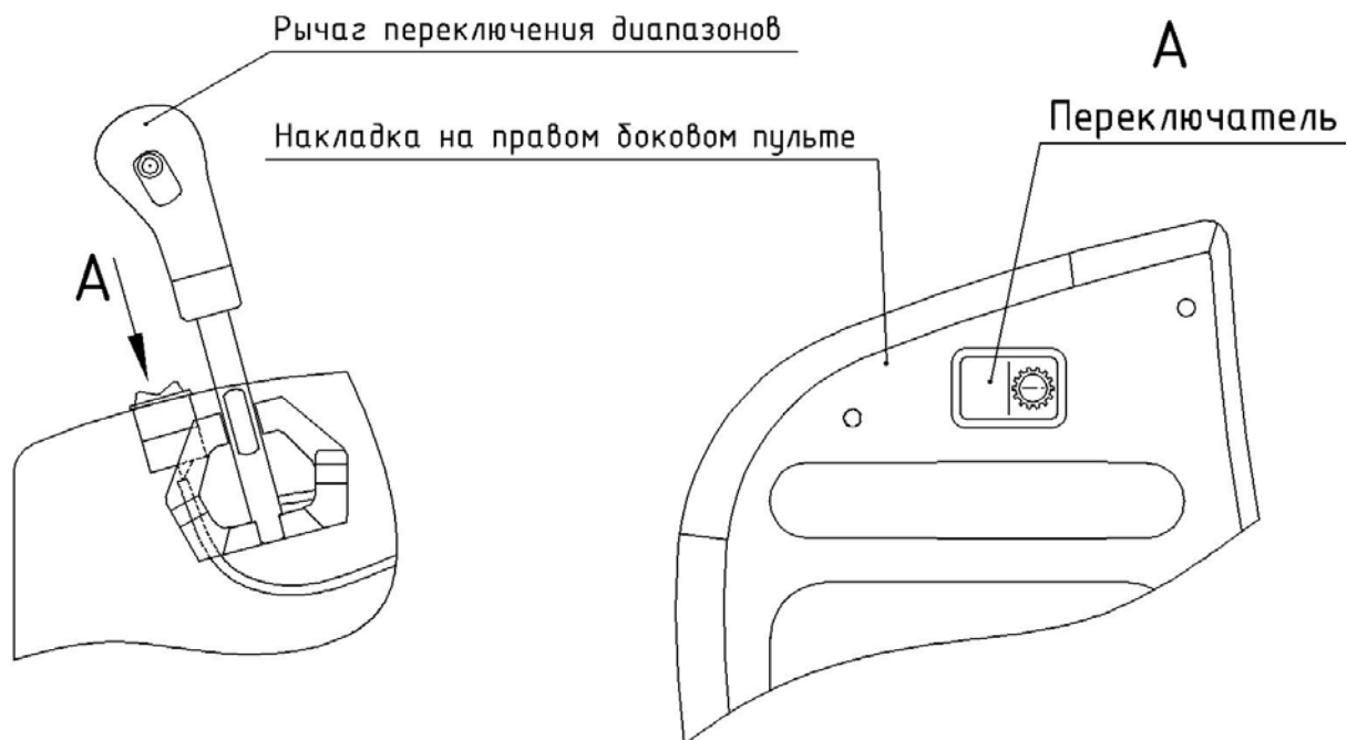
Рисунок 30 - Переключатель аварийного управления трансмиссией при перегреве двигателя трактора «Беларус-3022ДЦ.1»
